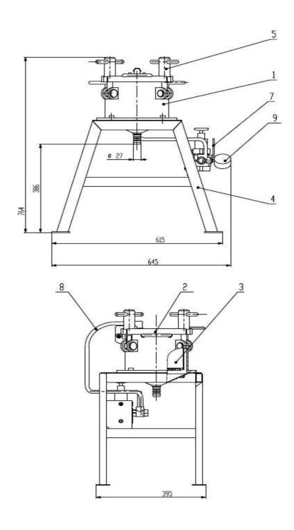
Рис.1 1- корпус; 2-крышка; 3-стакан; 4-рама; 5-винт; 6-пневмоклапан; 7- кран; 8-подводка (гибкий рукав); 9-манометр.
