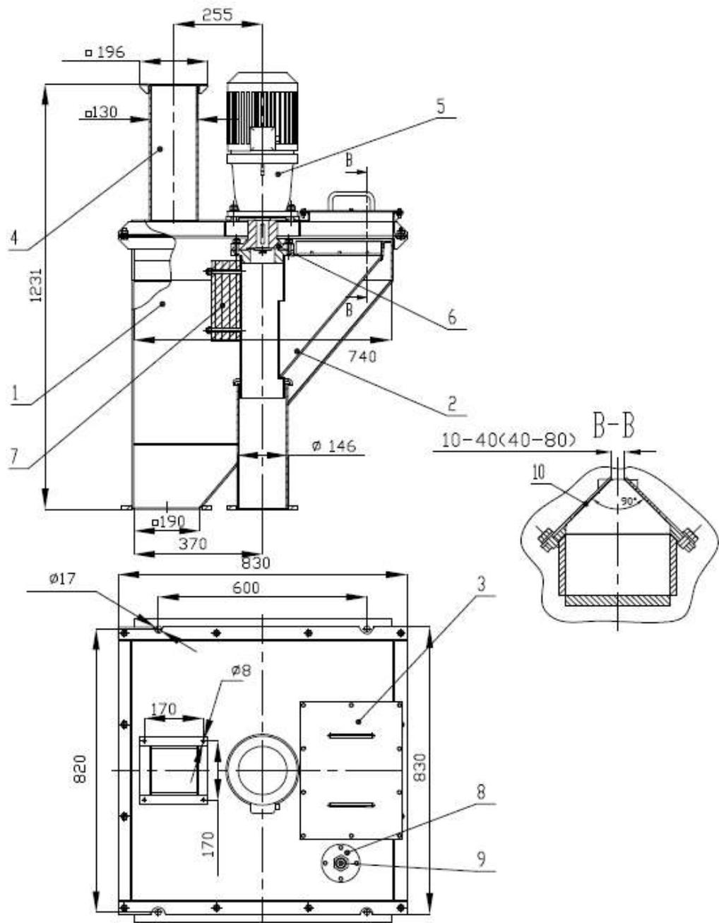
1 – Корпус; 2 – Ковш; 3 – Крышка; 4 – Крышка; 5 – Мотор-редуктор; 6 – Ступица; 7 – Противовес; 8 – Крышка; 9 – Датчик; 10 – Накладка.
