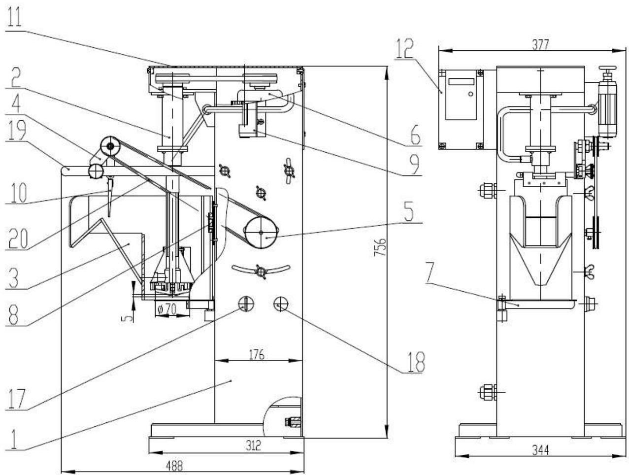
1 – Корпус; 2 – Блок импеллера; 3 – Камера; 4 – Пеногон; 5 – Привод пеногона; 6 – Двигатель привода импеллера; 7 – Столик; 8 – Направляющее устройство; 9 – Ротаметр; 10 – Лопатка; 12-Блок управления (ВПЧ); 17-Переключатель; 18-Лампа; 19-Штанга; 20-Пасик.
