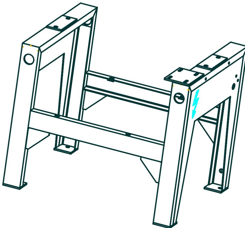
Рис.2. Рама сепаратора
