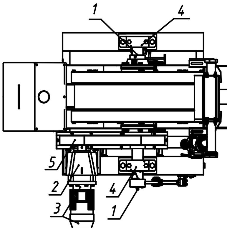
Рис.6. Расположение точек смазки
