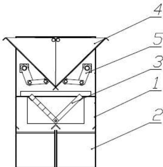
1 – Корпус; 2 – Ящик пробоприемник; 3 – Пластины; 4 – Воронка; 5 – Рычажный механизм; 6 – Пружина.
